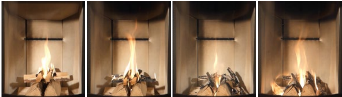
Anheizphase eines Kaminofens
